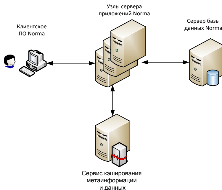
Рисунок 8 – Схема размещения кэша NORMA
