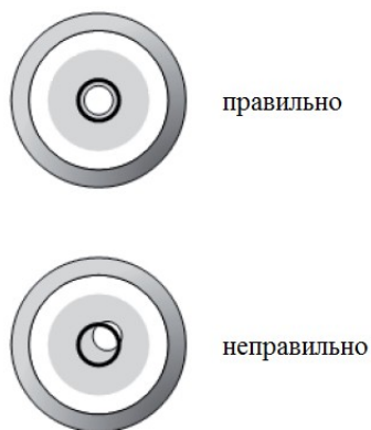
Рисунок 2. Контроль наклона основания с помощью пузырькового уровня.
