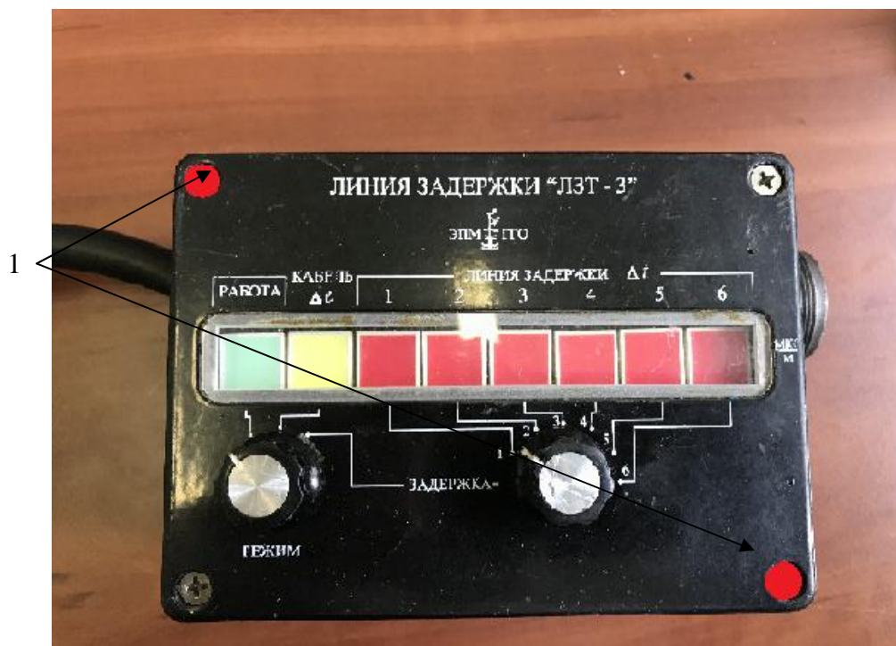
Рисунок 3 - Схема пломбирования линии задержки ЛЗТ-3 1 - пломбы на корпусе
