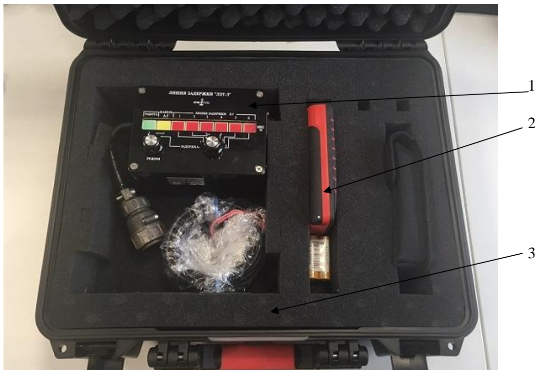
Рисунок 1 - Общий вид комплексов поверочных портативных КПП-6 1 - линия задержки ЛЗТ-3 2 - дальномер лазерный Leica DISTO D510 3 - кейс для хранения и перевозки
